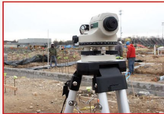
Máy thủy bình
